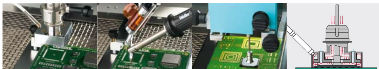
1. Rimozione/dissaldatura del componente difettoso
